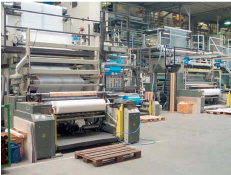
Extruder und Walzen müssen unterbrechungsfrei gekühlt werden, Ablagerungen im Kühlwasserkreislauf müssen vermieden werden.
